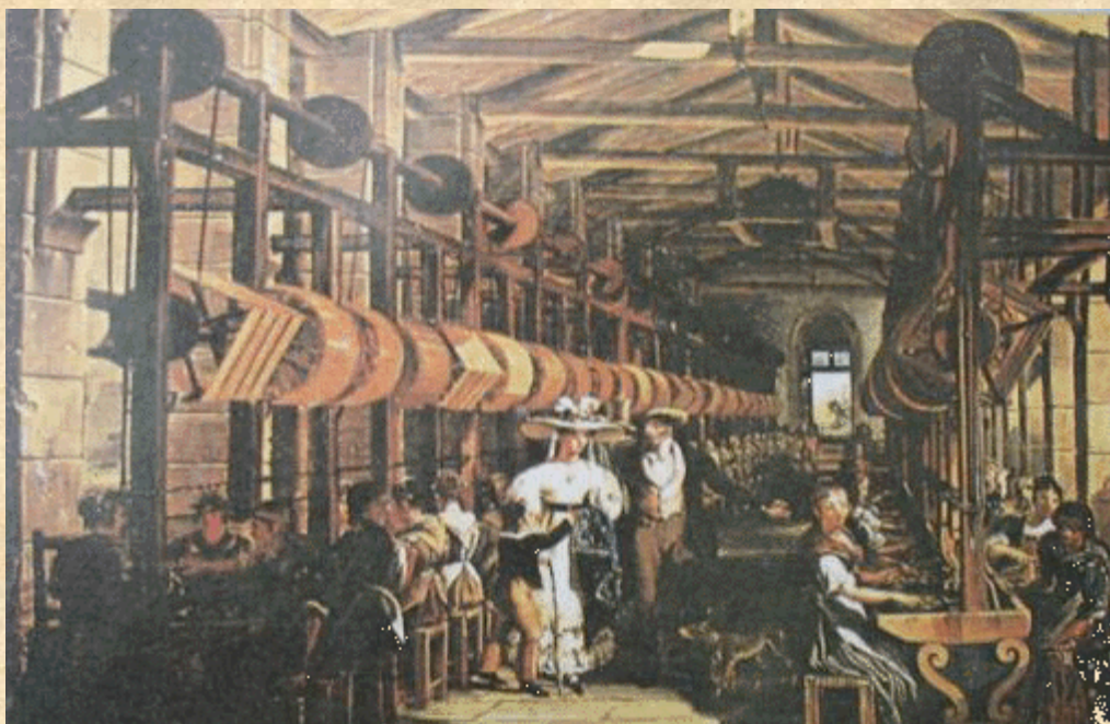
Una filanda (con macchine azionate da ruota idraulica)
