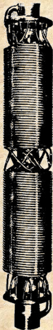
L'avvolgimento a solenoide per magnetizzare il sale paramagnetico
