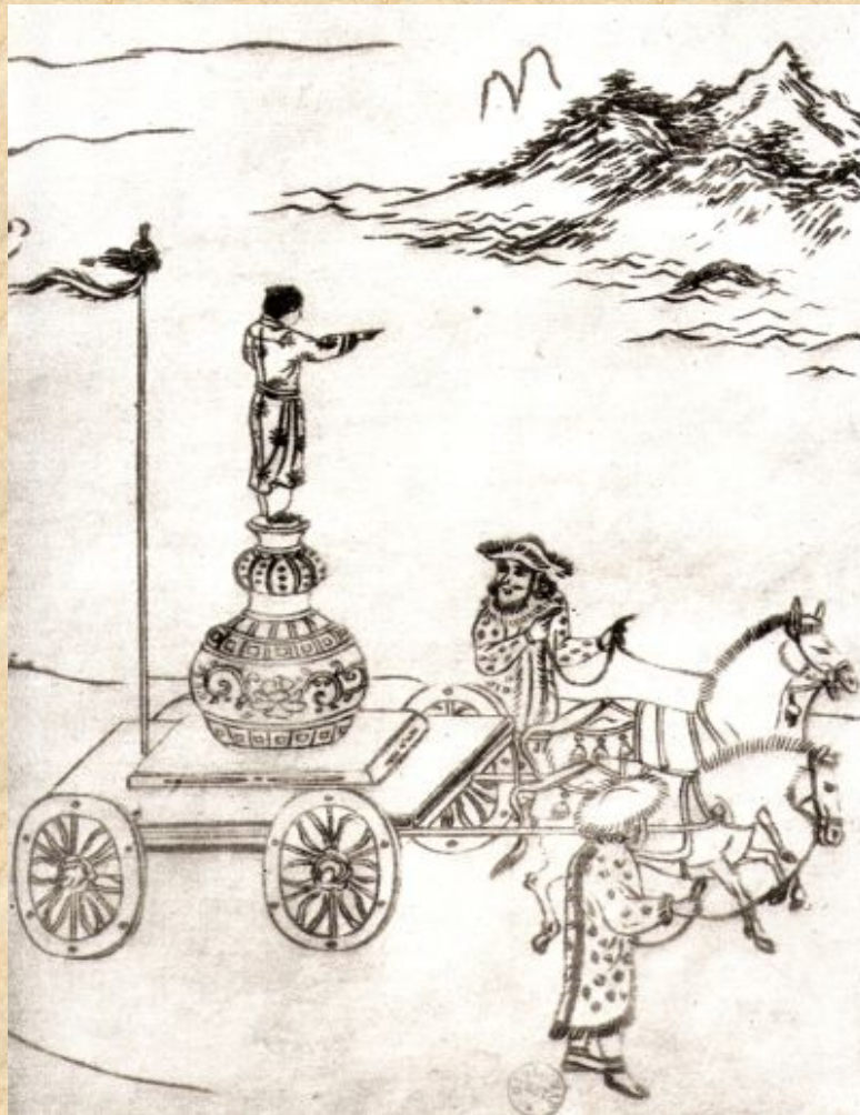
Carro cinese del sud con la statuina che può ruotare indicando il Sud
